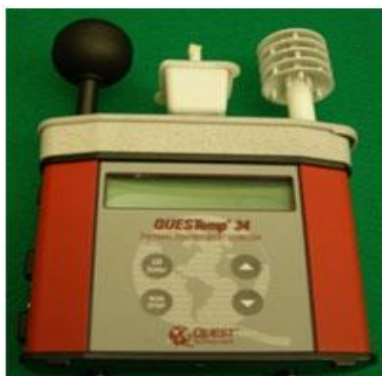
Figuur 1. Voorbeeld van een WBGT-meter, met T_g links, T_{nw} in het midden en T_a rechts.
