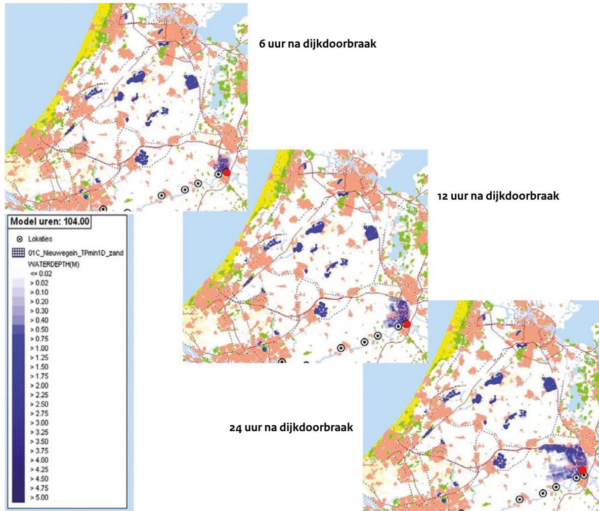
Figuur 3.4 Situatie op 6 uur, 12 uur en 24 uur na de dijkdoorbraak bij Nieuwegein (rode stip).
