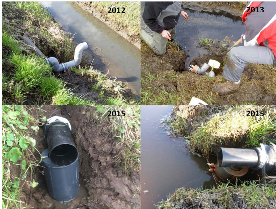
Figuur 1. Huidige ontwerp FlowCap blijkt niet geschikt voor het meten in drains op LMM-bedrijven
