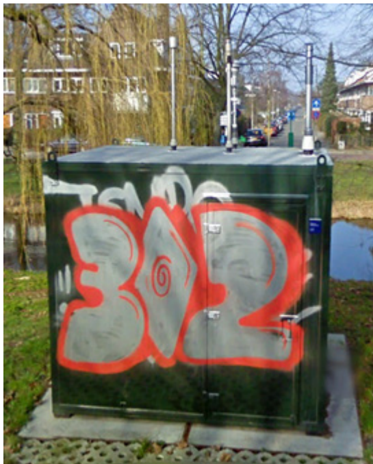
Afbeelding 5.12 Stedelijke meetstations van het Landelijk Meetnet Luchtkwaliteit van het RIVM in Utrecht (links) en van het meetnet van de GGD in Amsterdam. De 'pijpen' op de behuizing zijn de aanzuigingen voor de diverse meetsystemen. Foto's © Centrum voor Milieukwaliteit, RIVM (links) en GGD Amsterdam (rechts).
