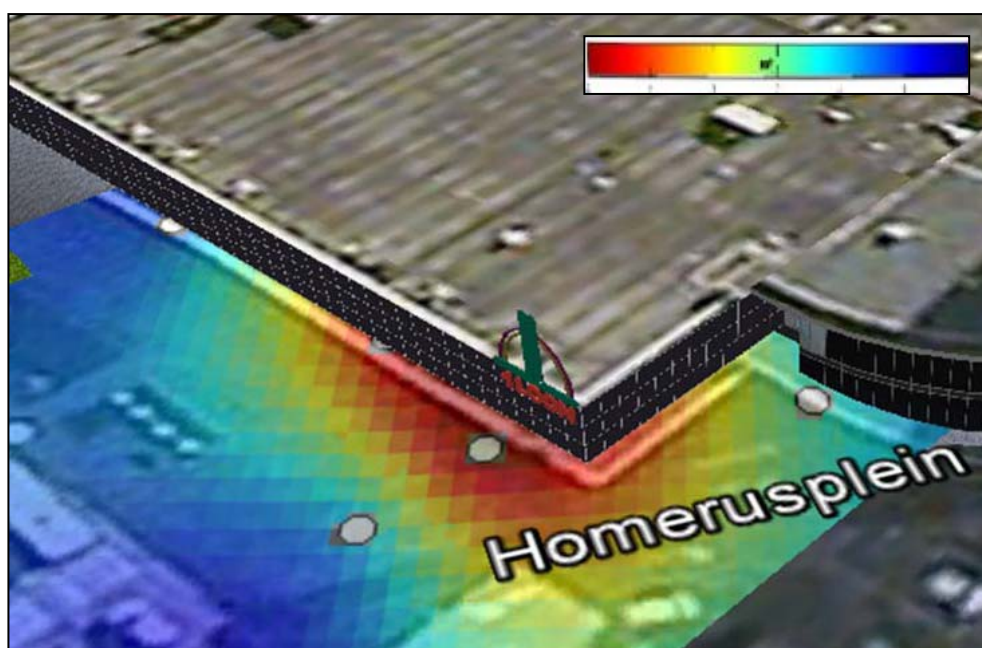
Figuur 10. Voorbeeld van een ernstige lokale bodemverplaatsing bij winkelcentrum Het Loon in Heerlen (Hanssen, 2011).
