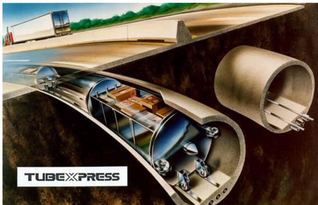
Figuur 3.1: Een modern capsule-pijpleidingsysteem. Bron: Tubexpress
