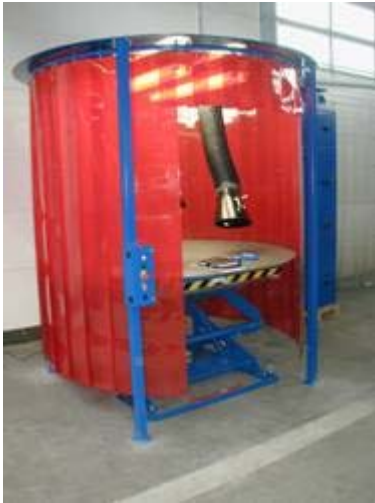
Figuur 14 Lamellengordijn met aan de voorzijde een werkopening voor laswerkzaamheden; binnen het gordijn in de afzuigmond zichtbaar
